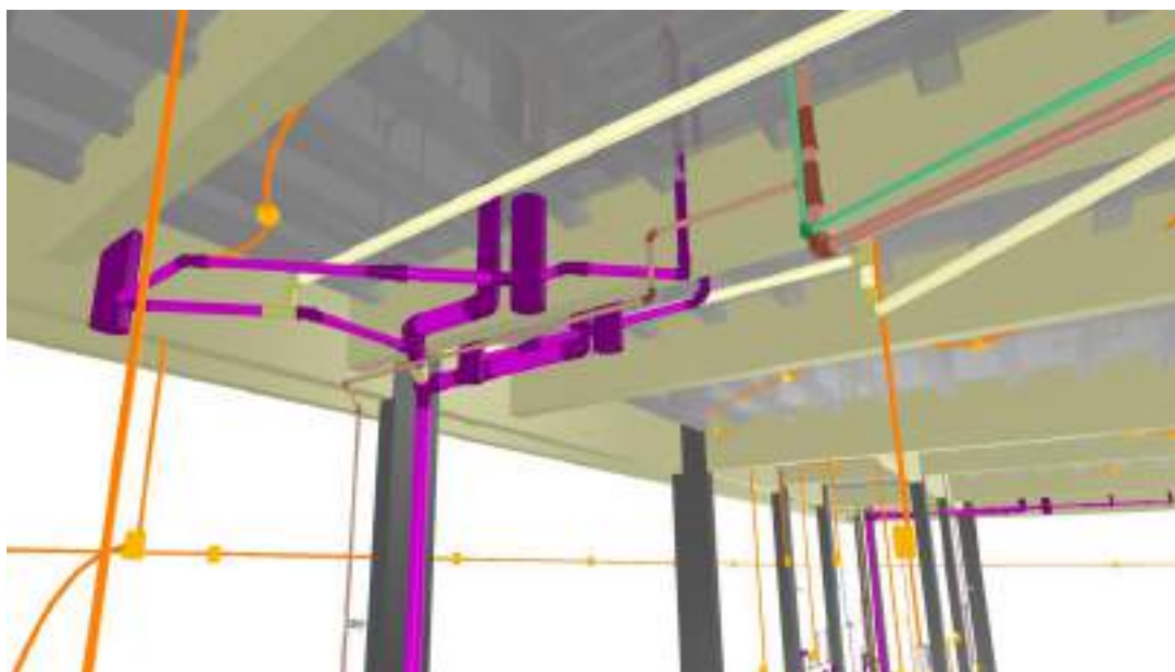
Figura 25 – Instalações sanitárias dos banheiros das suítes 01 e 02
