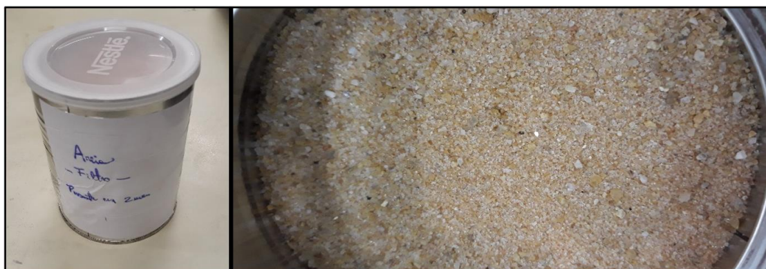
Figura 28 - Areia passante da peneira 2 \mu\text{m}
