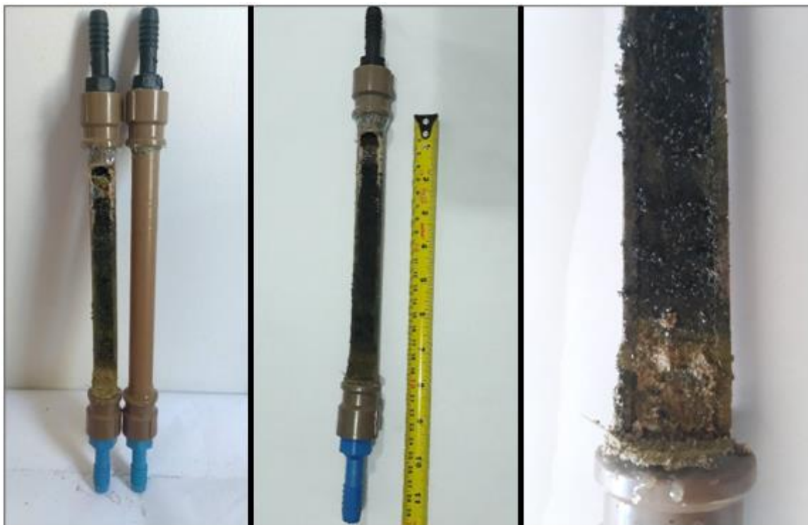
Figura 43 - Filtro de carvão e areia após ensaio de adsorção
