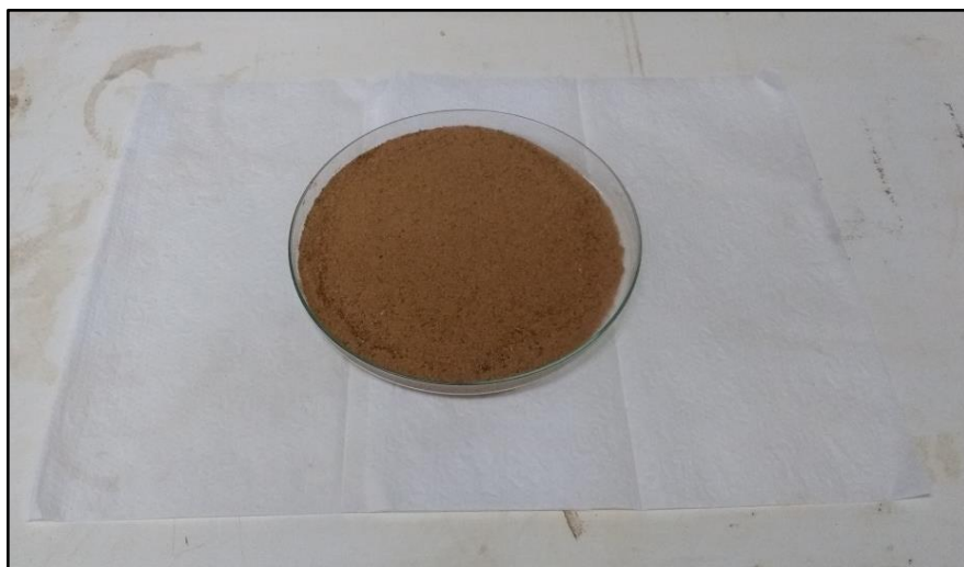
Figura 17 - Pó de serra peneirado
