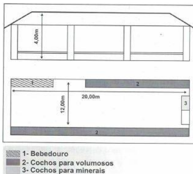
Figura 3. Esquema representativo de um confinamento de sistema fechado. O modelo apresenta um padrão para lotes de 50 animais. Fonte: (SILVA, 2008).
