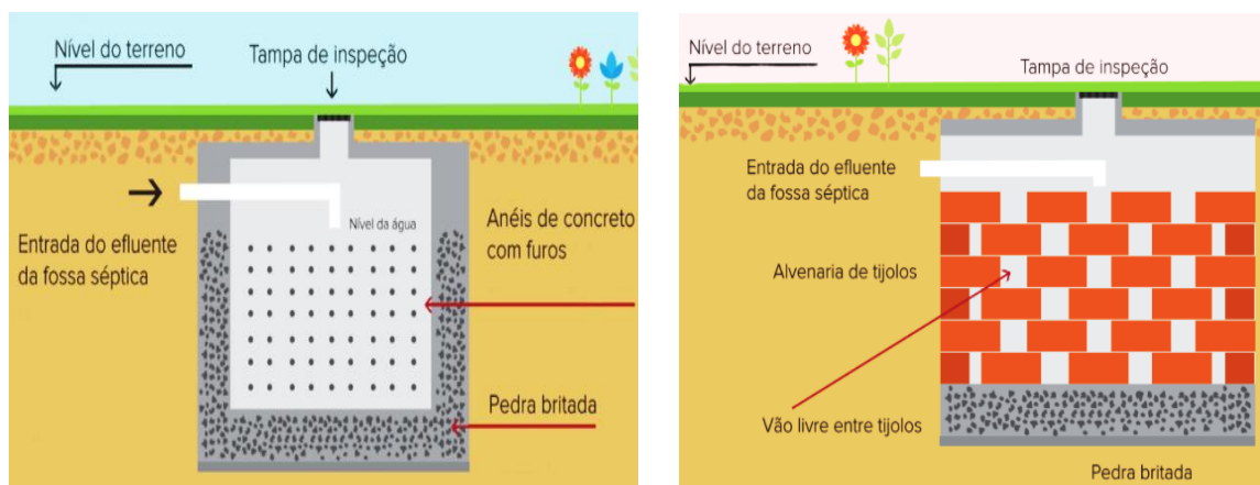
Figura 17 - Materiais mais comuns em sumidouro: concreto (esquerda) e blocos cerâmicos (direita)
