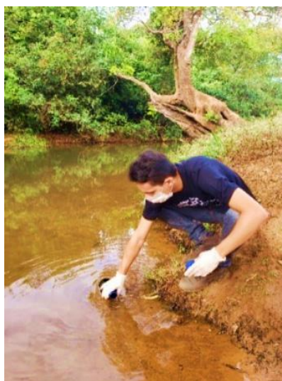
Figura 58 – Coleta de amostra de água para análise físico-química
