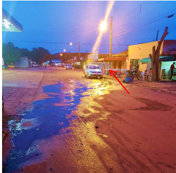
Figura 33 – Caminho preferencial dos extravasamentos das fossas na Rua Cícero Virgínio para pontos comerciais da praça municipal
