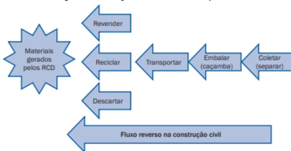
Figura 6: Fluxo logístico reverso na construção civil.
