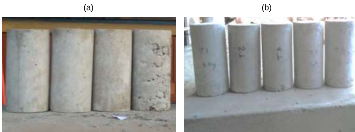
Figura 27 – Corpos de provas produzidos na etapa de dosagem: (a) Variando teor de água; (b) Variando teor de cimento
