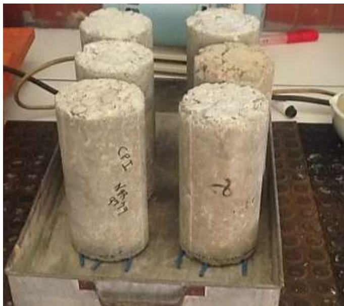
Figura 31 – Ensaio de absorção por capilaridade
