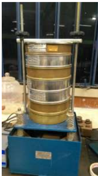
Figura 24 – Ensaio de granulometria dos agregados miúdos
