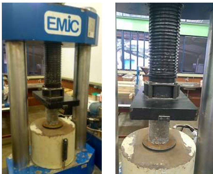
Figura 29 - Ensaio de resistência a compressão axial: (a) Vista de completa; (b) Vista ampliada
