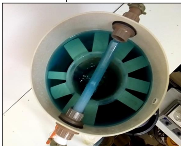
Figura 22 - Sistema de filtração de corante em carvão obtido da pirólise de resíduos da poda de árvore
