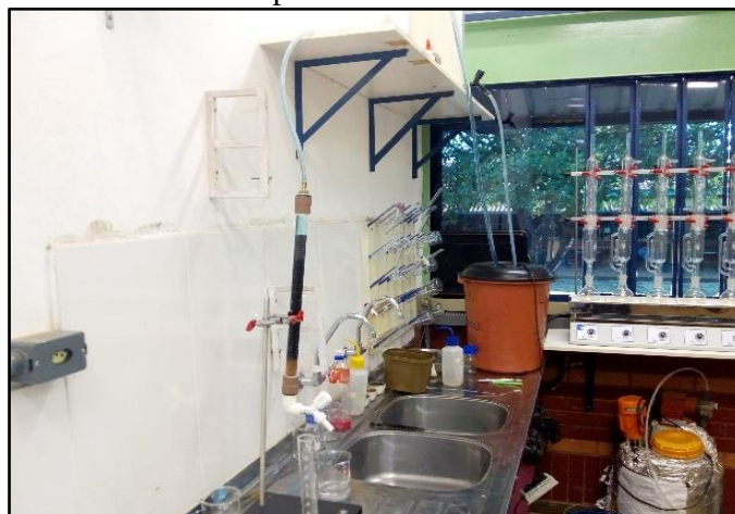
Figura 21 - Sistema de filtração de corante em carvão obtido da pirólise de resíduos da poda de árvore
