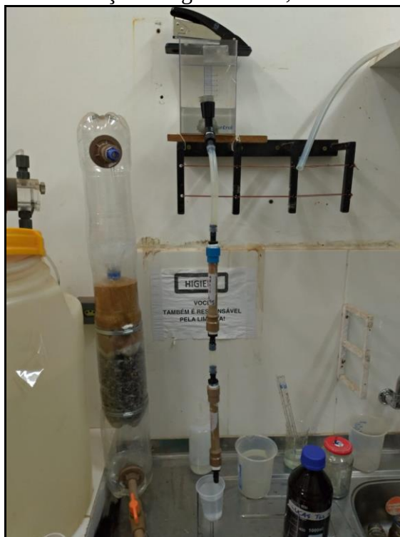
Figura 26 - Sistema de filtração de águas cinzas, contendo dois filtros em série
