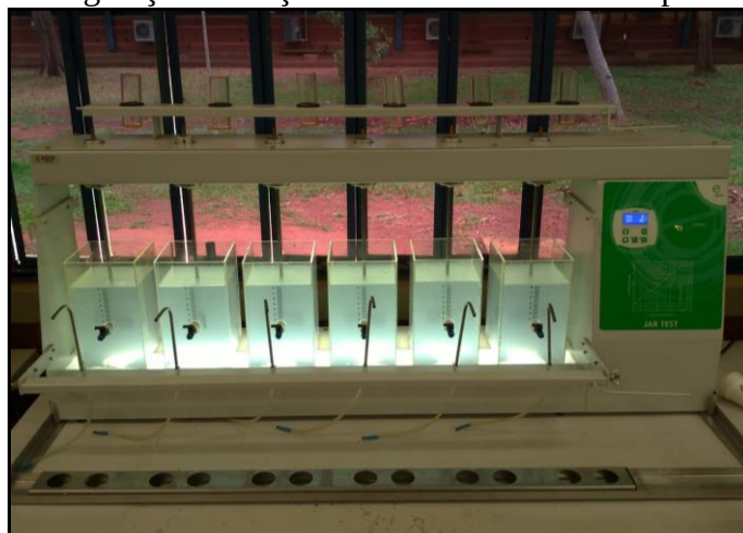
Figura 25 - Coagulação/Filtração do efluente utilizando aparelho JAR Test
