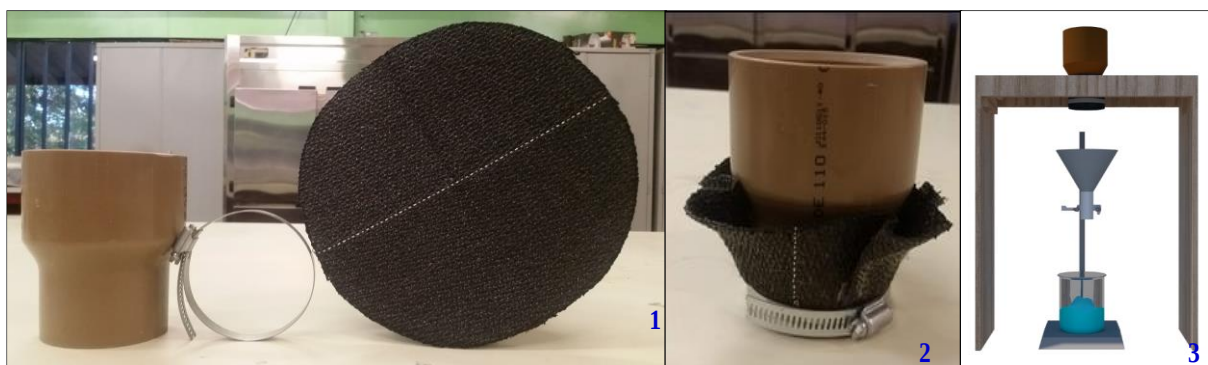
Figura 3.7 - Sistema de bancada desenvolvido para desaguamento de resíduo em geotêxtil
