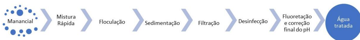
Figura 2.1 - Fluxograma de uma estação de tratamento de ciclo completo
