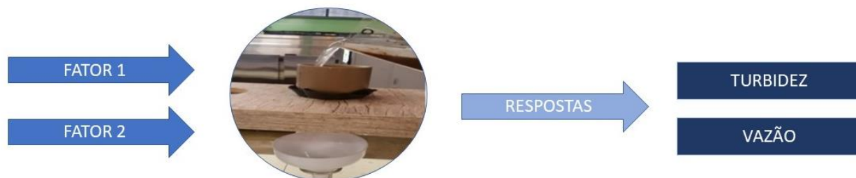
Figura 3.6 - Representação do DFC ( 2^2 ) utilizado no desaguamento por tecido geotêxtil em escala de bancada
