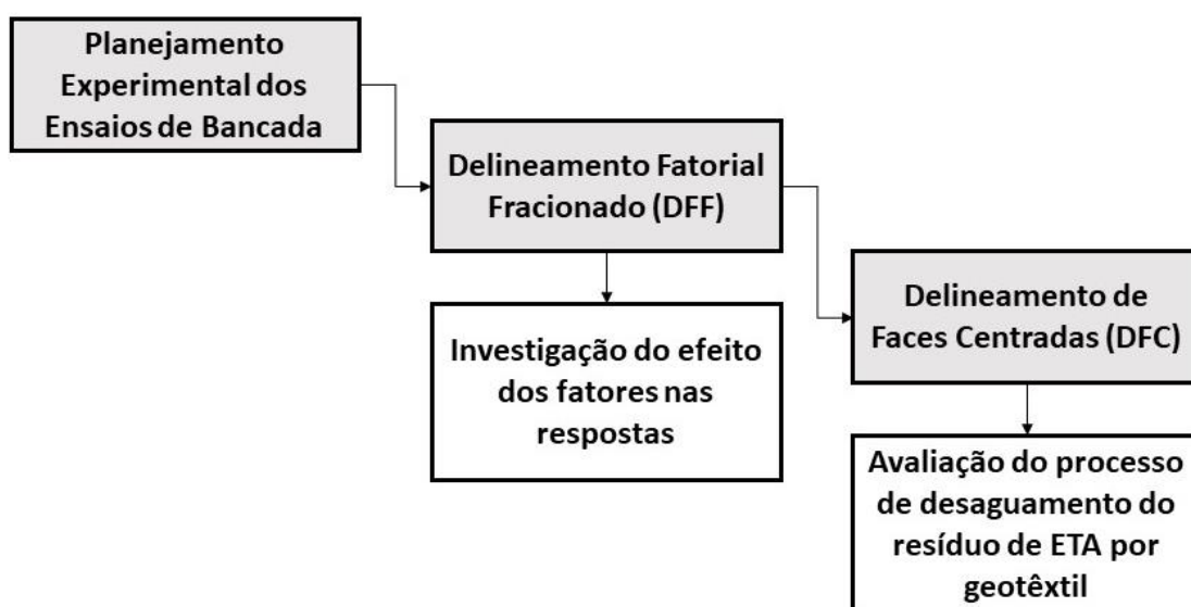
Figura 3.4 - Fases do planejamento experimental dos ensaios de bancada
