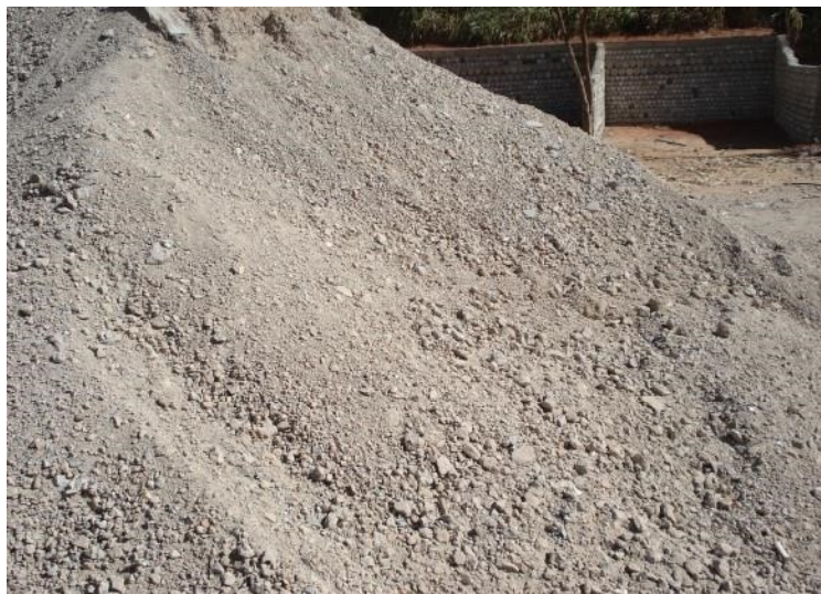
Figura 1. Resíduos de construção classe A
