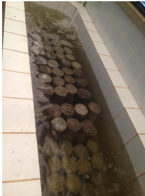
Figura 21. Cura do concreto
