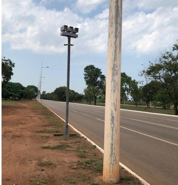
Figura 24 – Equipamento fixo de fiscalização de velocidade.
