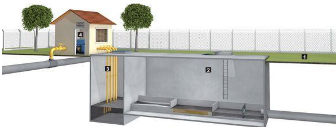
Figura 2 – Estação Elevatória de Esgoto
