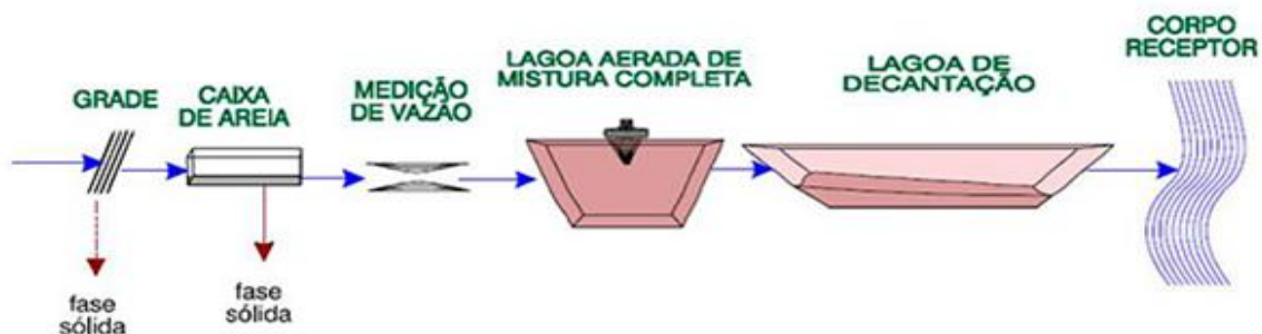
Figura 7 – Lagoa Aerada de Mistura Completa
