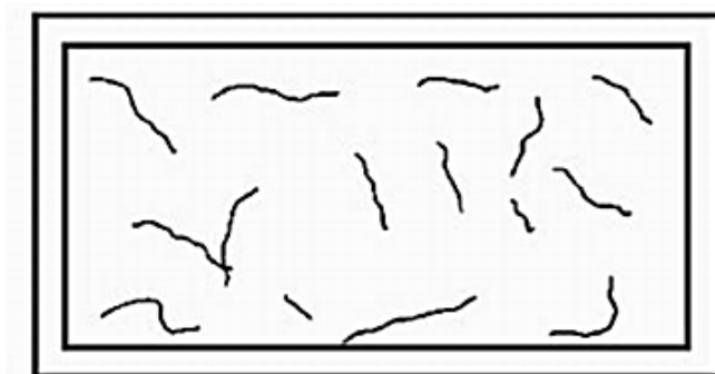
Figura 5 – Fissuras de retração em laje de concreto
