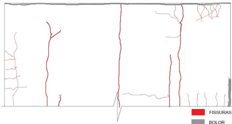
Figura 68 – Mapeamento das manifestações patológicas na marquise da biblioteca, sem escala
