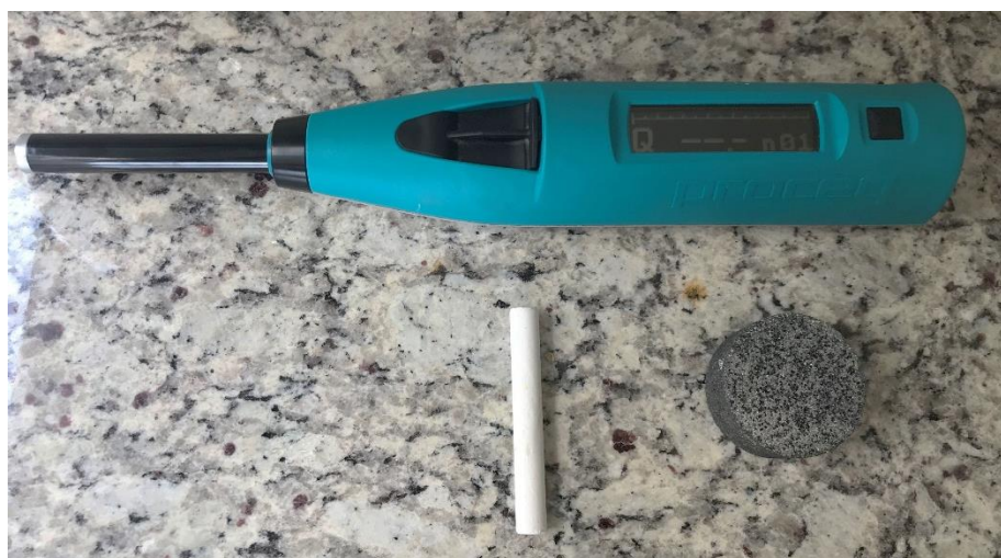
Figura 33 - Materiais utilizados no ensaio de esclerometria
