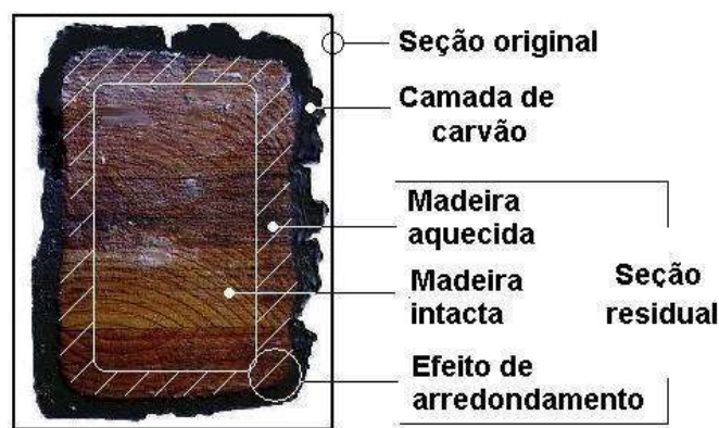
Figura 14 - Seção Transversal Residual
