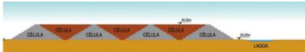
Figura 7: Corte esquemático do aterro sanitário.
