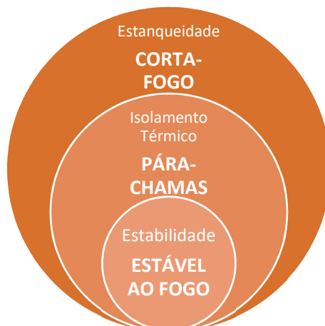
Figura 6 – Classificação de resistência ao fogo
