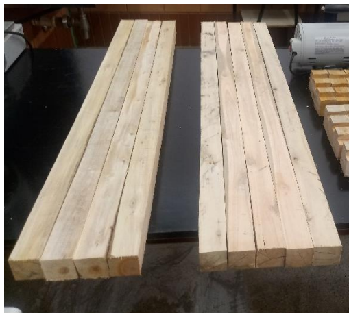
Figura 21. Corpos de prova para ensaio de flexão
