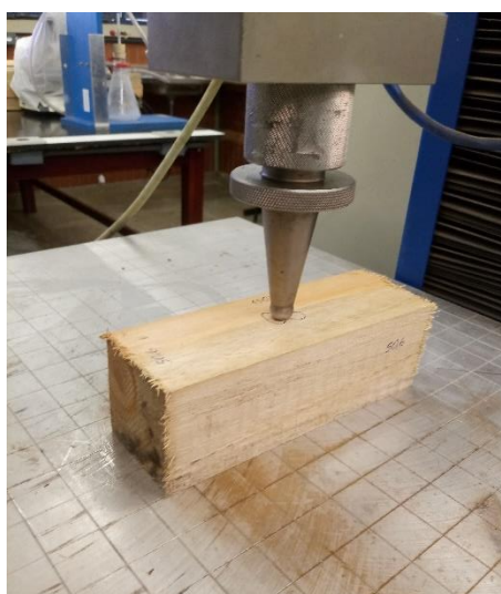
Figura 23. Ensaio mecânico de dureza Janka normal às fibras
