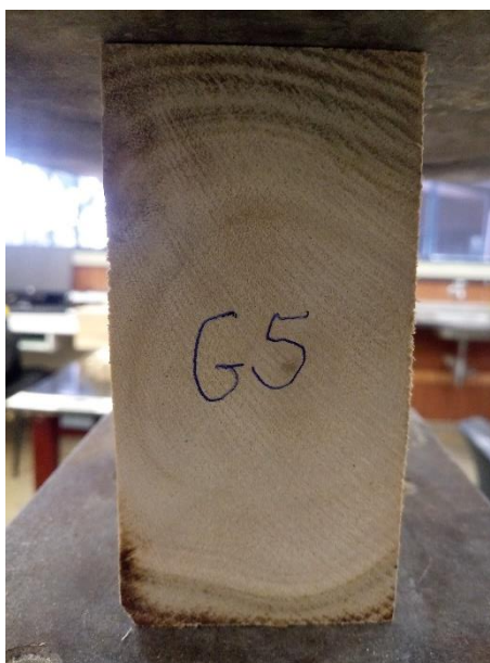
Figura 17. Ensaio de compressão normal às fibras
