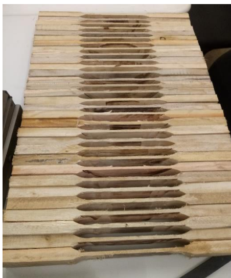
Figura 16. Corpos de prova para ensaio de tração paralela às fibras
