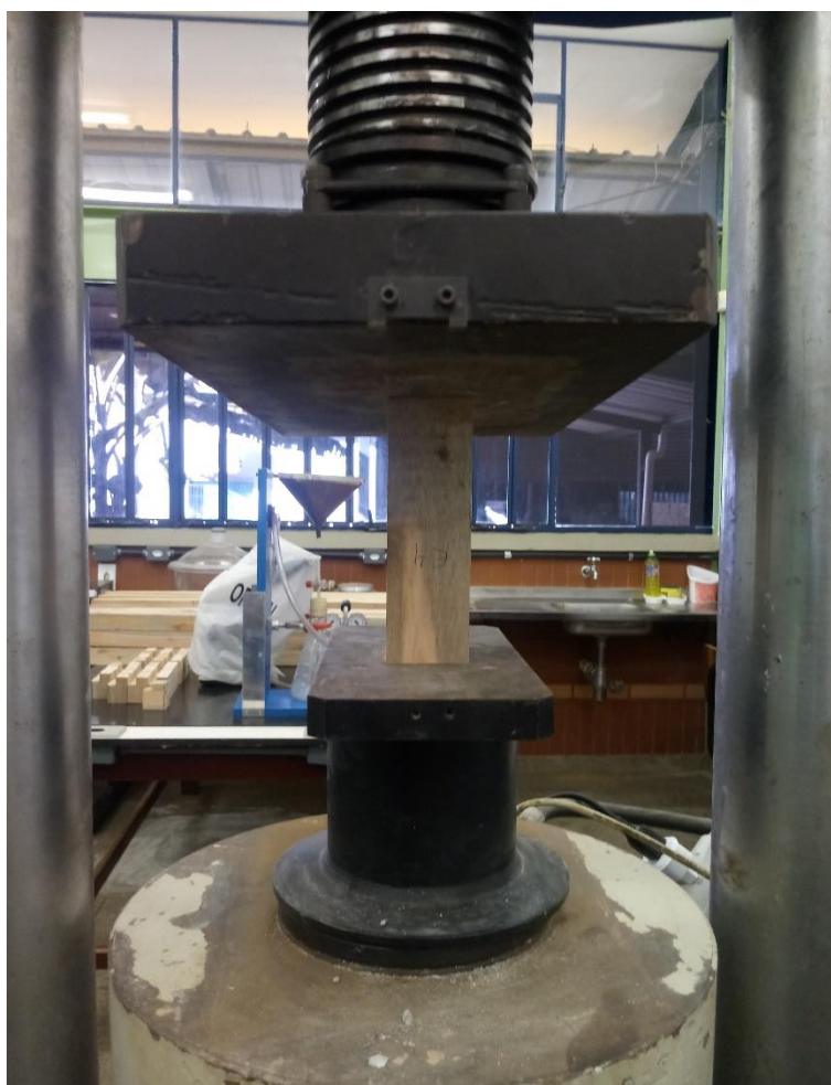
Figura 15. Ensaio de compressão paralela às fibras
