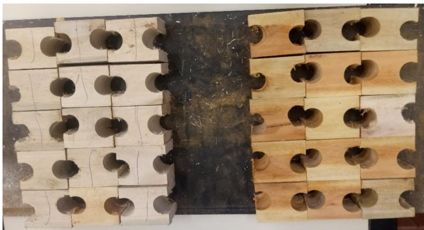
Figura 18. Corpos de prova para ensaio de tração normal às fibras
