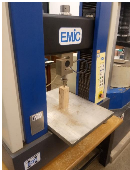
Figura 22. Ensaio mecânico de dureza Janka paralela às fibras
