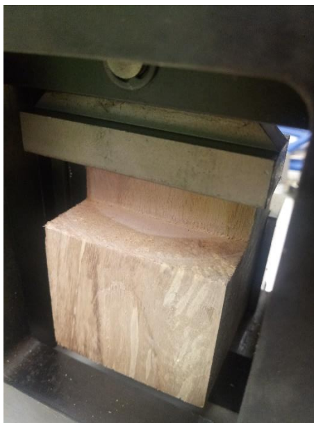
Figura 19. Corpo de prova para ensaio mecânico de cisalhamento
