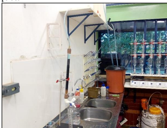
Fotografia 7 – Sistema de filtração de corante em carvão obtido da pirólise de bagaço de cana-de-açúcar.
