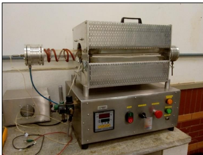
Fotografia 6 – Reator de leito fixo empregado nos experimentos de pirólise de biomassa.
