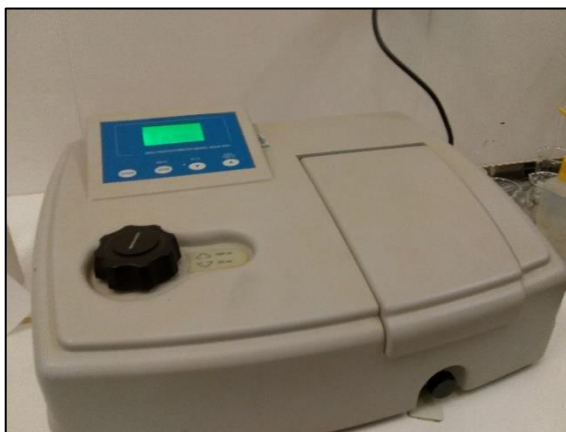
Fotografia 9 – Análise espectrofotométrica do corante após sistema de filtração.
