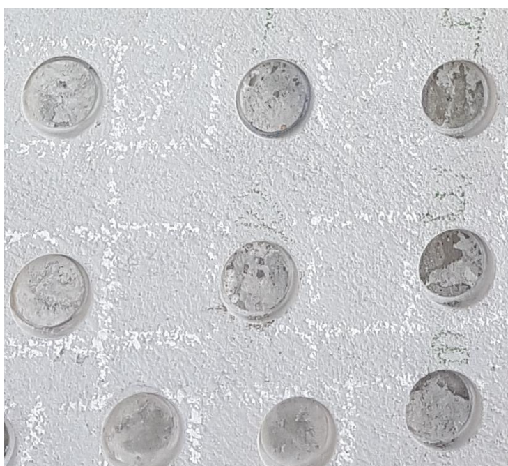
Figura 30 - Detalhe da ruptura de alguns corpos de prova
