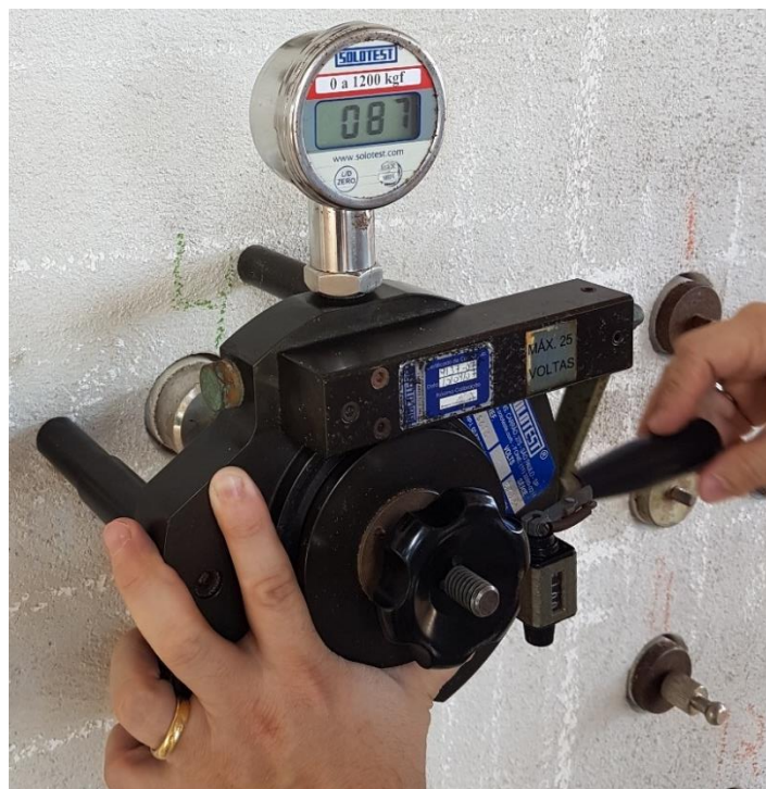
Figura 28 – Dinamômetro utilizado para arrancamento dos corpos de prova
