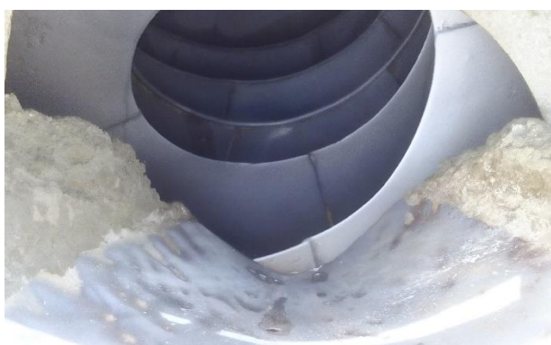
Figura 18 – Pás do caminhão-betoneira
