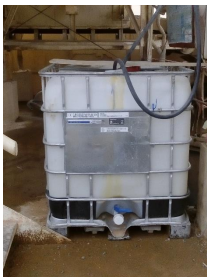
Figura 11 – Armazenamento adequado do aditivo
