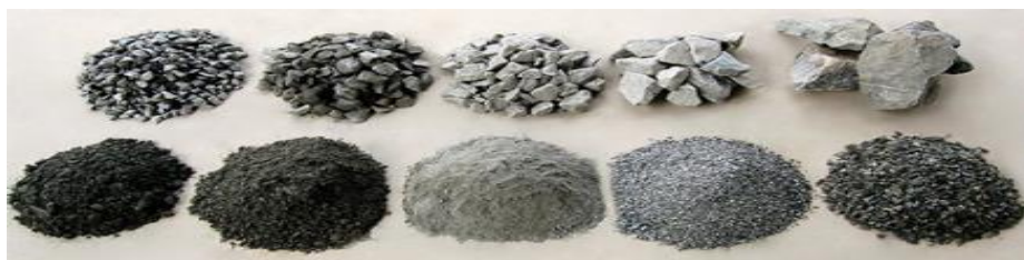
Figura 2- Tipos de Britas mais comuns produzidas por Rochas Carbonáticas
