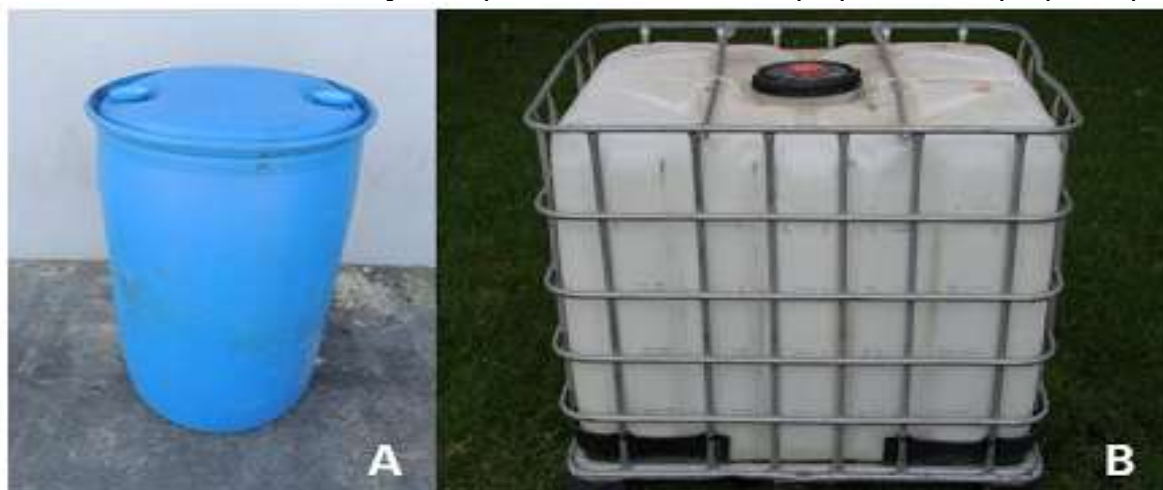
FIGURA 2 – Tonel de 200 L (A) e container tipo IBC ( intermediate bulk container - B) de 1.000 L utilizados na criação de peixes em sistemas aquapônicos de pequeno porte
