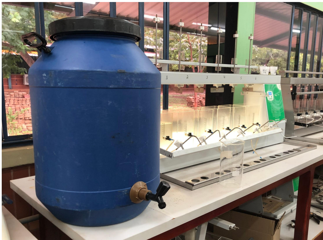
Figura 3 — Jar Test utilizado nos ensaios para o tratamento ao lado da minicisterna de águas cinza
