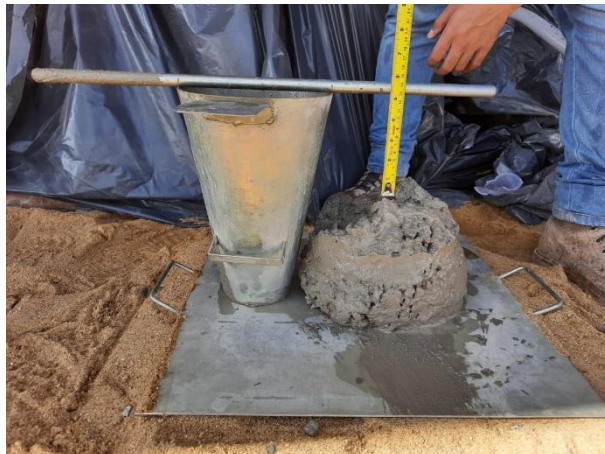
Figura 16 – Medição do abatimento.
