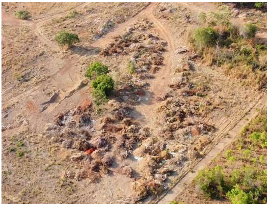
Figura 14 – Deposição de RCC e galhadas
