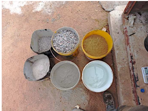
Figura 20 - Separação de materiais por massa
