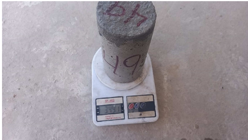
Figura 21 - Identificação e pesagem de corpos de prova
