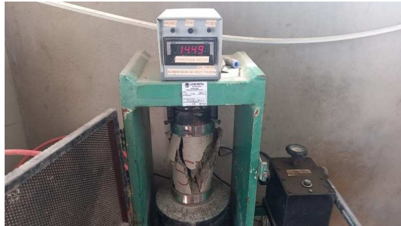
Figura 23 - Exemplo de ruptura de corpo de prova
