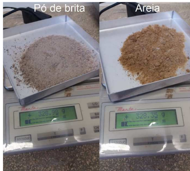
Figura 19 - Verificação de umidade Areia e Pó de brita
