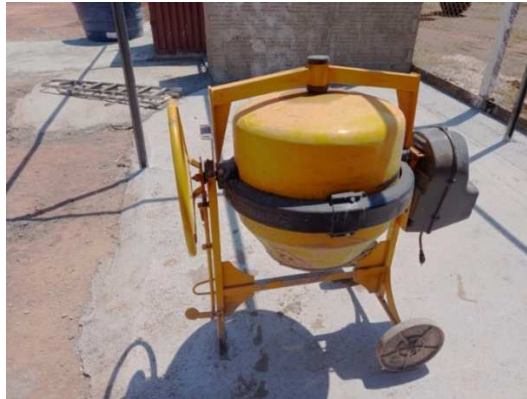
Figura 16 - Betoneira 150L utilizada
