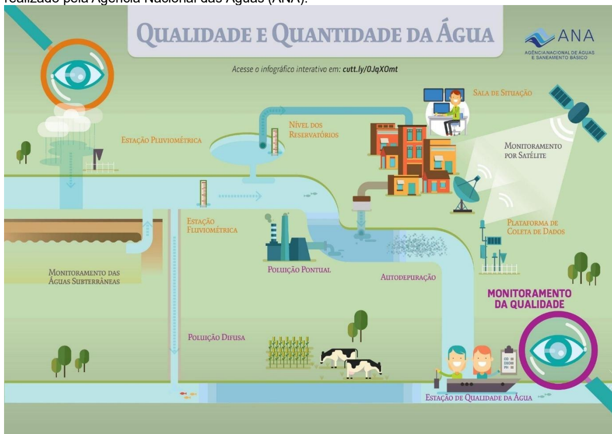
Figura 1 – Esquema simplificado do monitoramento da qualidade e quantidade de água no Brasil, realizado pela Agência Nacional das Águas (ANA).
