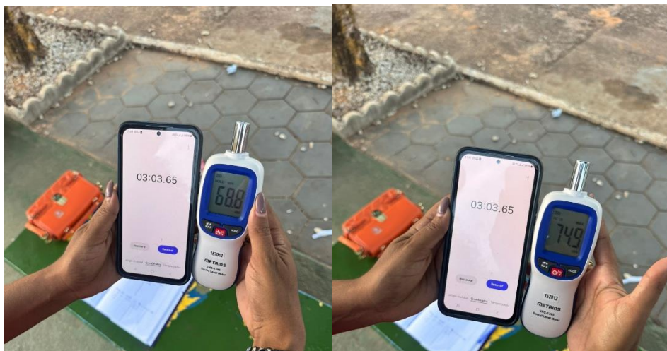
Figura 18 Medições de pressão sonora em frente à escola - 2º dia fim do turno vespertino
