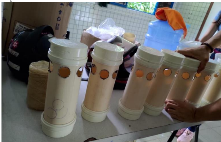
Figura 2 - Armadilhas do tipo Pitfalls, com furos. Essa armadilha é enterrada apenas de forma em que sua abertura fique nivelada com a superfície.
