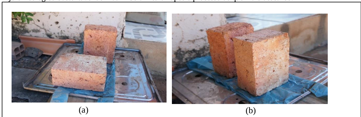
Figura 23 - (a) Tijolo Ecológico Sustentável de Matriz Cerâmica 01 após o processo de queima e esfriamento. (b) Tijolo Ecológico Sustentável de Matriz Cerâmica 02 após o processo de queima e descanso.
