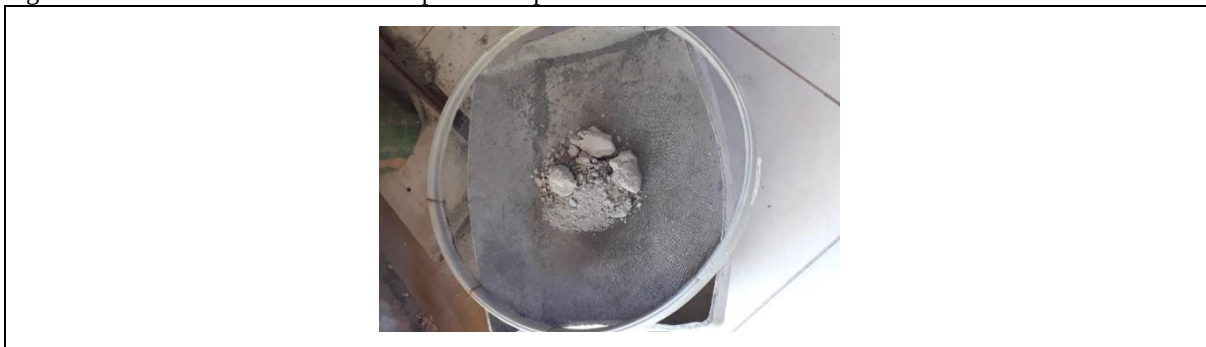
Figura 05 - Cimento endurecido sendo peneirado para ser utilizado.
