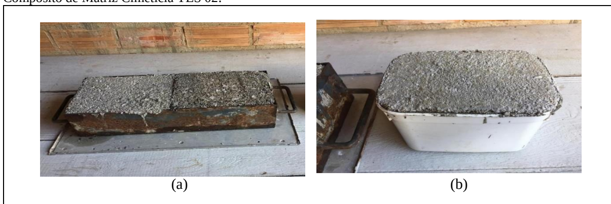
Figura 19 - (a) Compósito de Matriz Cimetícia TES 01 do lado direito e Compósito de Matriz Cimetícia TES 02 do lado esquerdo em fôrma metálica. (b) Fôrma alternativa de plástico reciclado contendo o restante da mistura do Compósito de Matriz Cimetícia TES 02.
