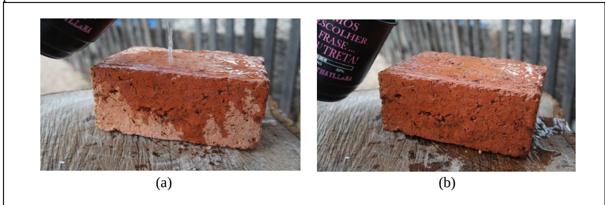
Figura 26 - (a) Demonstração da água sendo despejada sobre o TES de matriz cerâmica 02. (b) A água foi parcialmente absorvida.
