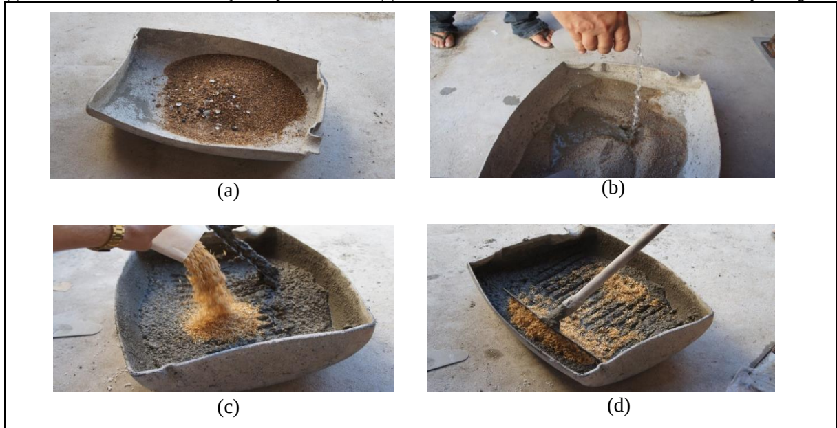
Figura 17 - (a) Adicionando os compostos na masseira. (b) Colocando água para umidificar os compostos e facilitar na mistura. (c) Acrescentando os últimos compostos para a mistura. (d) Misturando os resíduos com o auxílio do ancinho de jardinagem.
