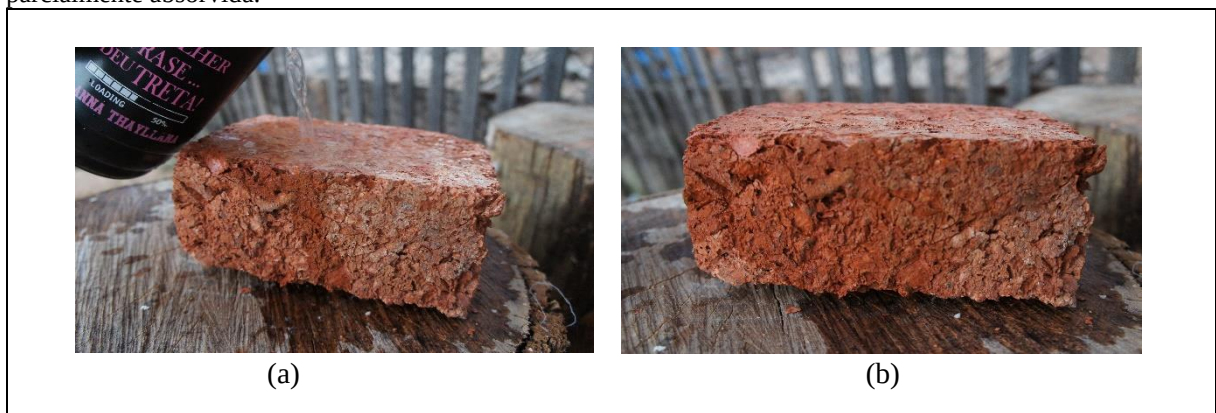
Figura 25 - (a) Demonstração da água sendo despejada sobre o TES de matriz cerâmica 01. (b) A água foi parcialmente absorvida.
