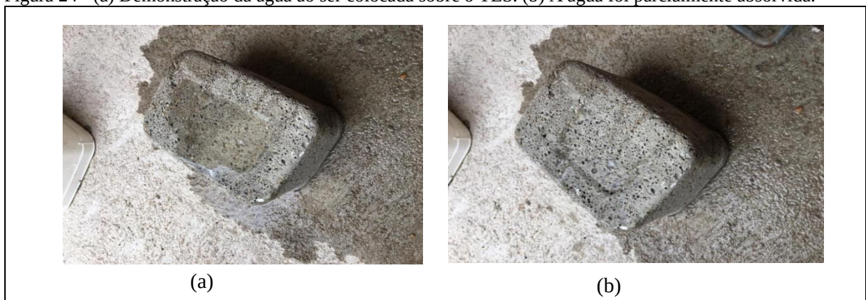
Figura 24 - (a) Demonstração da água ao ser colocada sobre o TES. (b) A água foi parcialmente absorvida.
