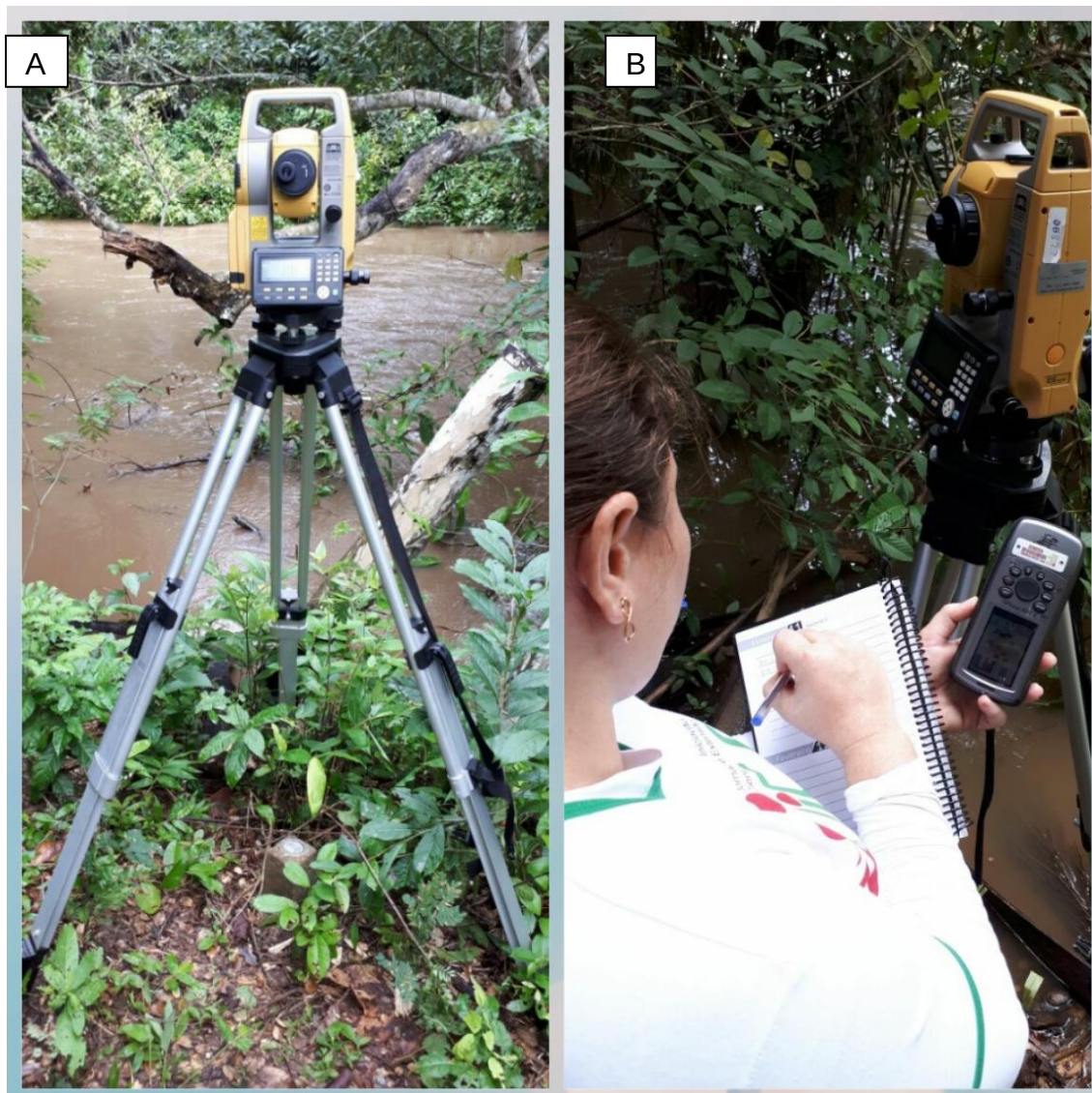
Figura 3 – Levantamento da largura do córrego (A – Levantamento topográfico com Estação Total; B – Demarcação dos pontos com GPS).
