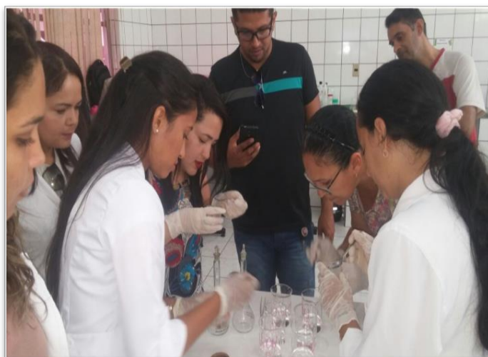
Figura 7: Separação dos insetos em copos de becker em soluções KOH 2% e NaOH 5%
