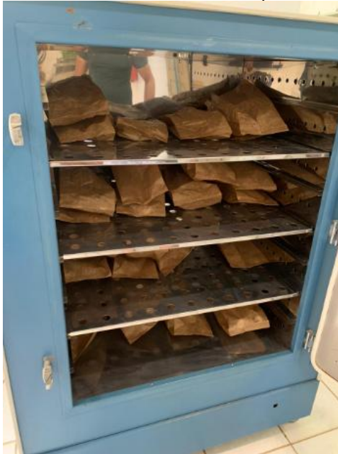
Figura 12. Amostras acondicionadas na estufa a 65 °C para determinação da massa seca
