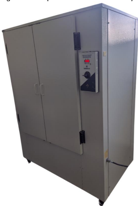
Figura 6 – Estufa de secagem com renovação e circulação de ar utilizada no laboratório de Tecnologia e Produção de sementes do campus .
