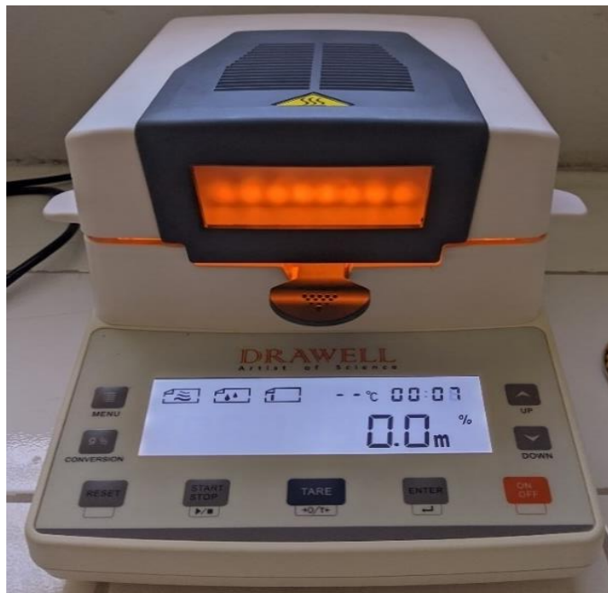
Figura 11 – Testador de Umidade Halógeno iniciando a dessecação da amostra
