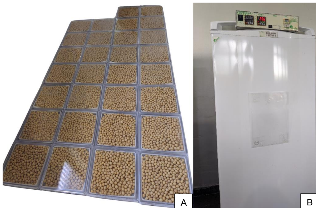
Figura 5 – Amostras prontas na caixa Gerbox (A) e incubadora LT 320 TFP – II (B)
