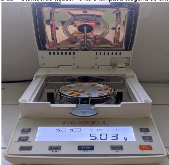
Figura 12 – Câmara de aquecimento e lâmpada alógena do analisador
