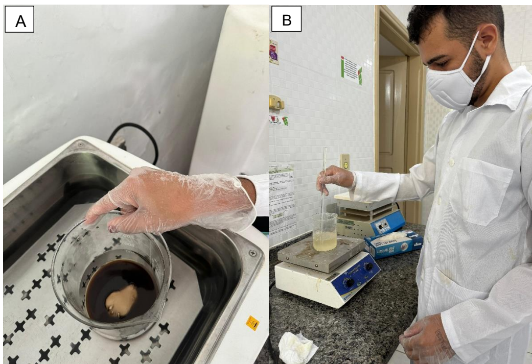
Figura 6. Derretimento da cera de abelha em banho-maria (A), saponificação do óleo de coco (B).
