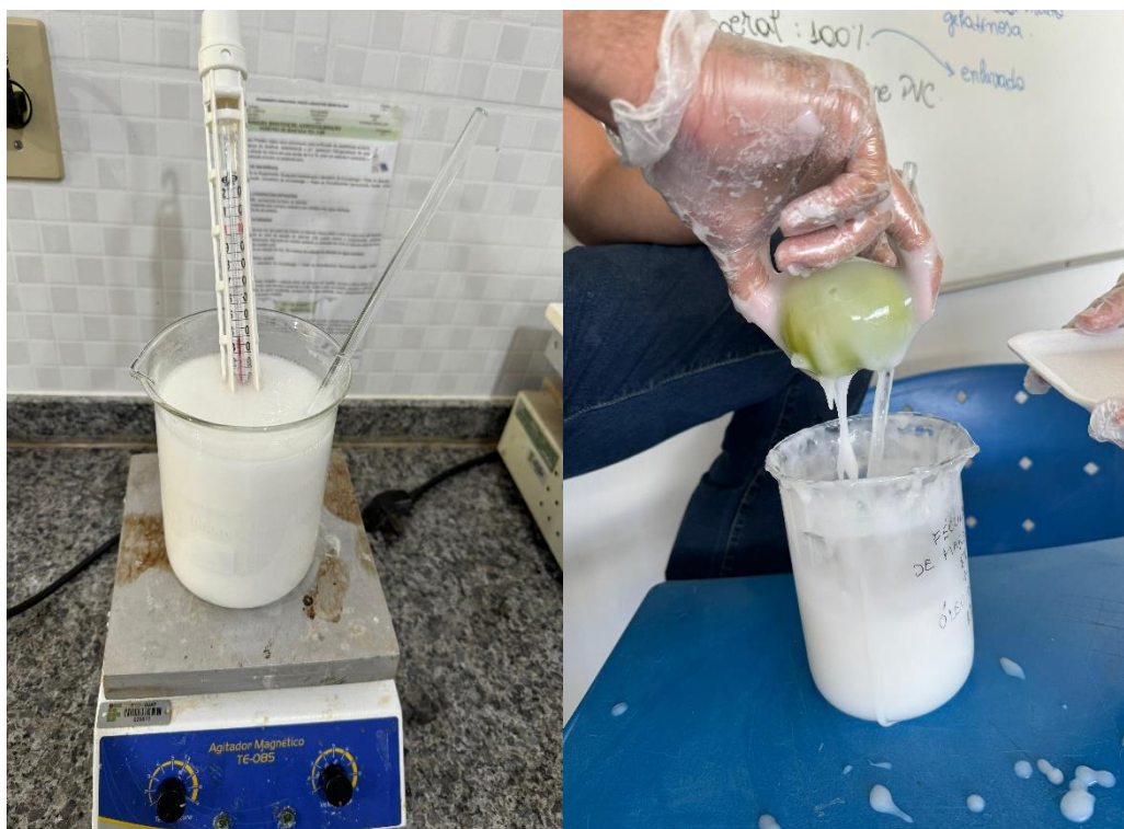
Figura 4. Preparo e aplicação do revestimento de fécula de mandioca (8%) + (1%) Óleo de coco babaçu.
