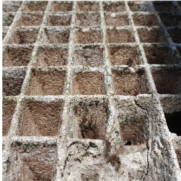
Figura 04. Desgastes e fissuras em bandejas de isopor.
