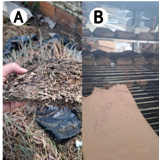
Figura 7. a) Coleta de substrato para análise; b) Secagem de substrato estufa
