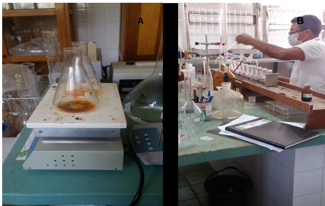
Figura 4- Erlenmeyer com solução de dicromato de potássio e solo em placa elétrica (A) e processo de titulação (B).
