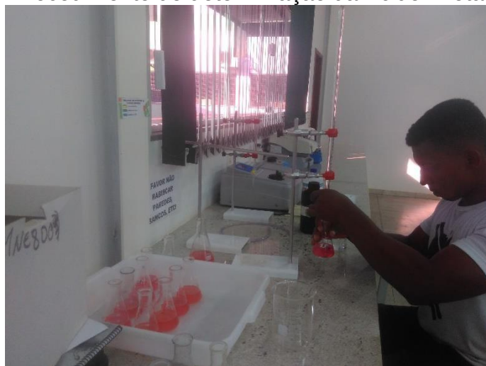
Figura 12: Procedimento de determinação da Acidez Total Titulável.
