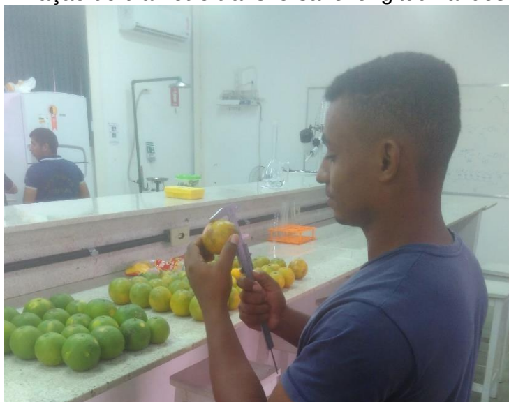
Figura 07: Determinação do diâmetro transversal e longitudinal dos frutos.
