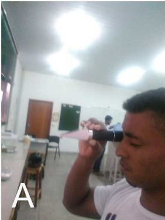
Figura 11: Procedimento de leitura por refratometria (A) e escala de leitura do refratômetro (B).
