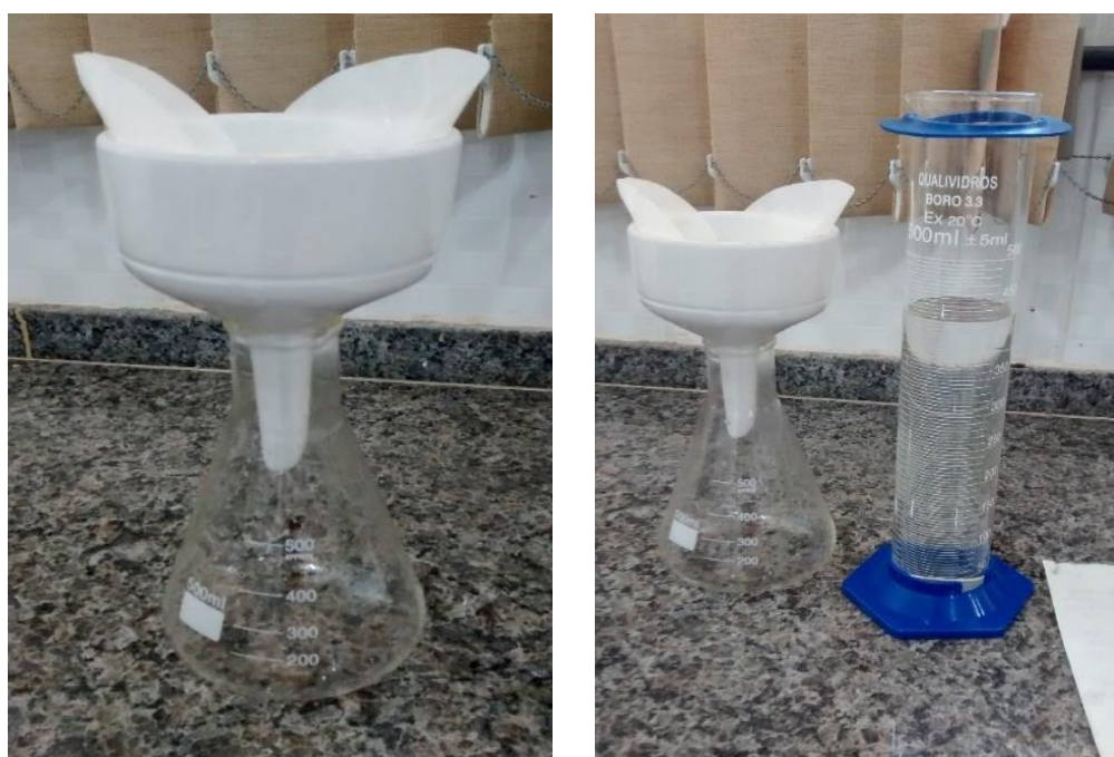
FIGURA 1: Funil e papel filtro dispostos sobre um erlenmeyer antes (à esquerda) e transcorridos 15 minutos da adição de água à amostra de areia (à direita).
